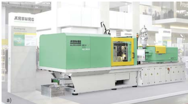
2. ábra. Arburg fröccsgép (a) és a gyártott termékek (b)
