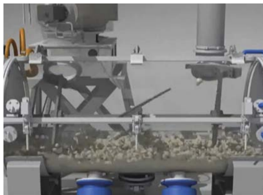
24. ábra. A Plas Mec hűtőegység belseje [13]
