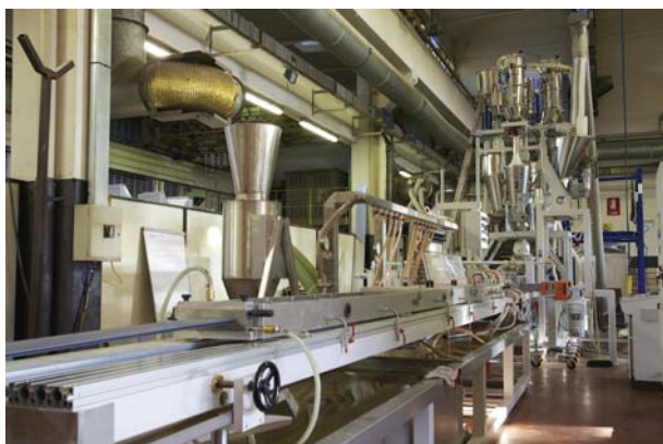
8. ábra. Komplett ICMA WPC gyártósor [2]
