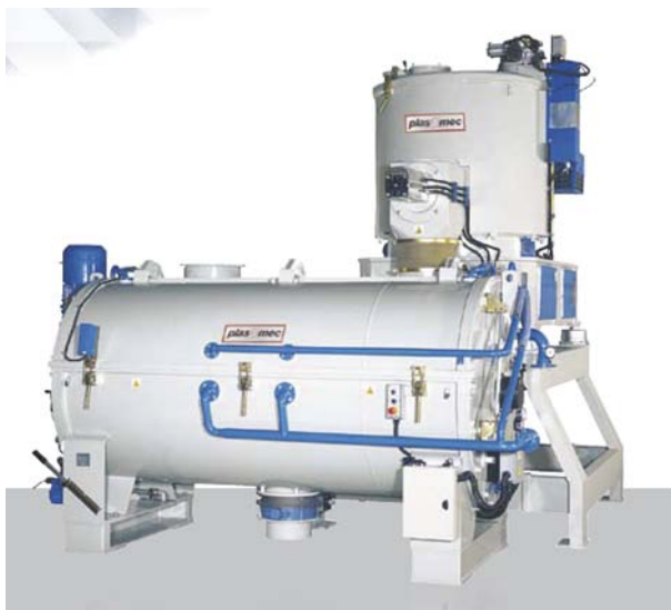
22. ábra. Plas Mec fűtő-hűtő keverő [13]
