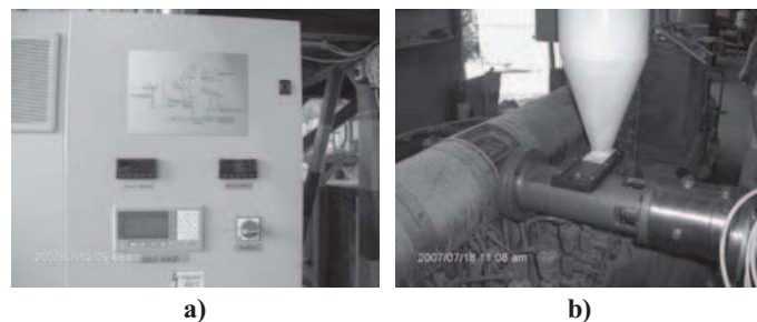
11. ábra. Félüzemi kompaundáló berendezés műszerezése (a) és oldaladagolója (b)
